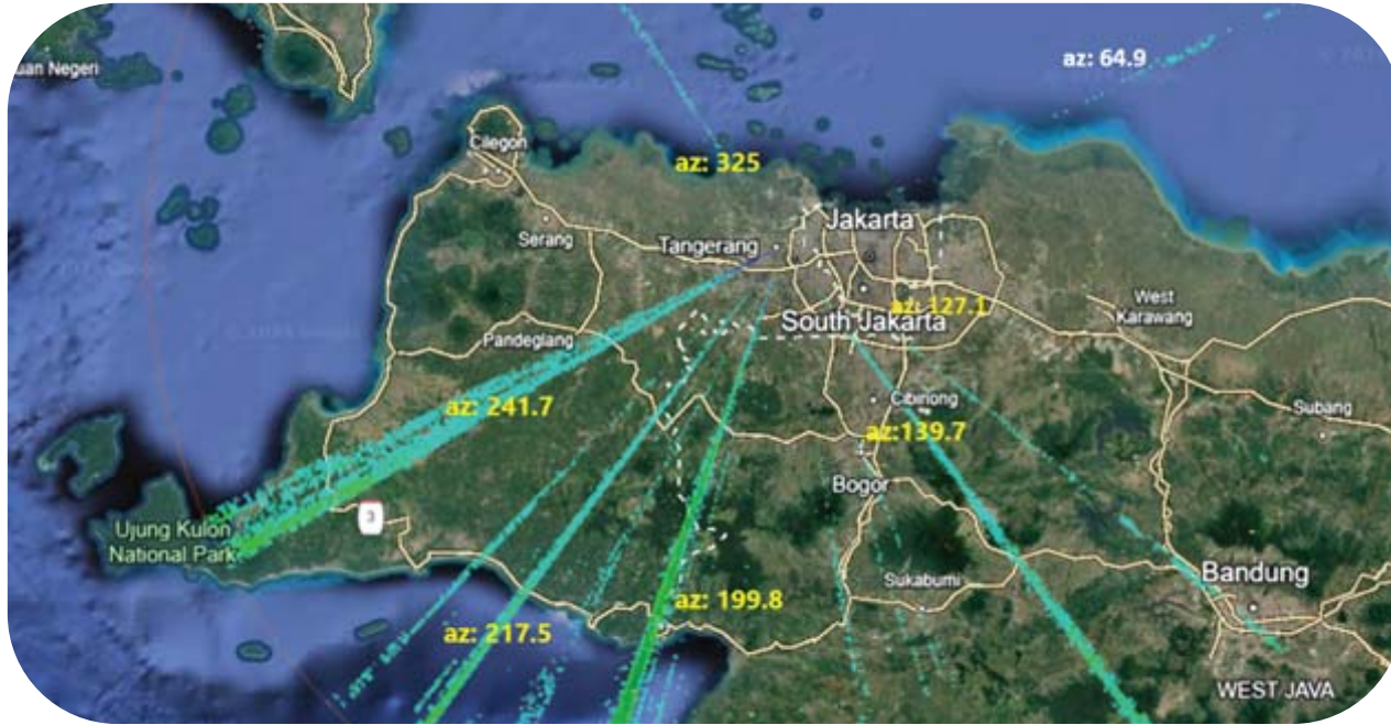
Gangguan pada Citra Radar Cuaca BMKG Stamet Kelas I Soekarno-Hatta Tangerang (sumber: Stamet Kelas I Soekarno-Hatta Tangerang)
